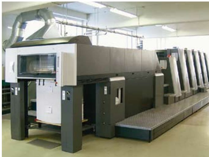
Die neue Heidelberg Speedmaster XL75-5+LX2 mit vollautomatischem simultanem Plattenwechsel.
